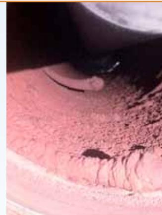
Das Bild zeigt einen ausgewachsenen Dendriten, der zum Kurzschluss der Zelle geführt hätte, wäre er nicht durch die Strömung tangential sondern radial gewachsen.
