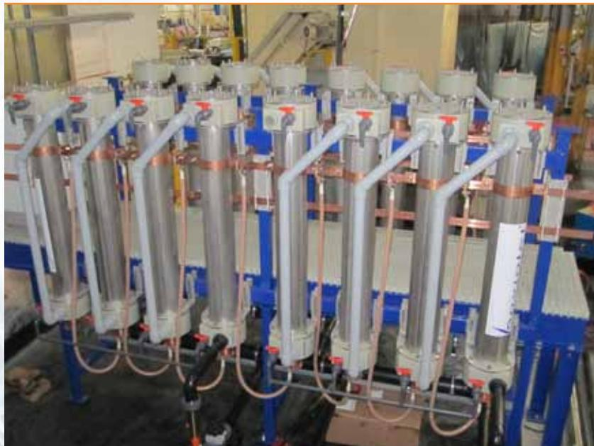
enviolet Elektrolyseanlage, bestehend aus 16 Kupferzellen, die um eine Gangway angeordnet sind.
