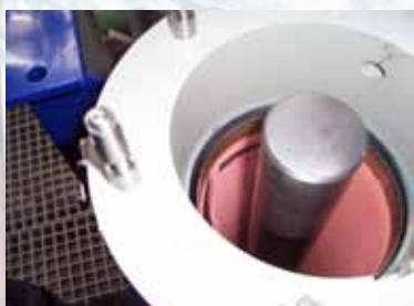
Die Fa. enviolet hat aus seinen über 20 Jahren bewährten, hydrodynamisch optimierten UV-Reaktoren eine strömungstechnisch ähnliche Elektrolysezelle abgeleitet. Im Zentrum der rotationssymmetrischen Zelle ist eine inerte Anode angeordnet. Als Kathode dienen die äußere Edelstahl-Umhüllung der Zelle. Im Ringspalt strömt der Elektrolyt in einer hoch-turbulenten Rotationsströmung. Dadurch wird die Dicke der hydrodynamischen Grenzschicht reduziert, wodurch die Überspannung sinkt.
