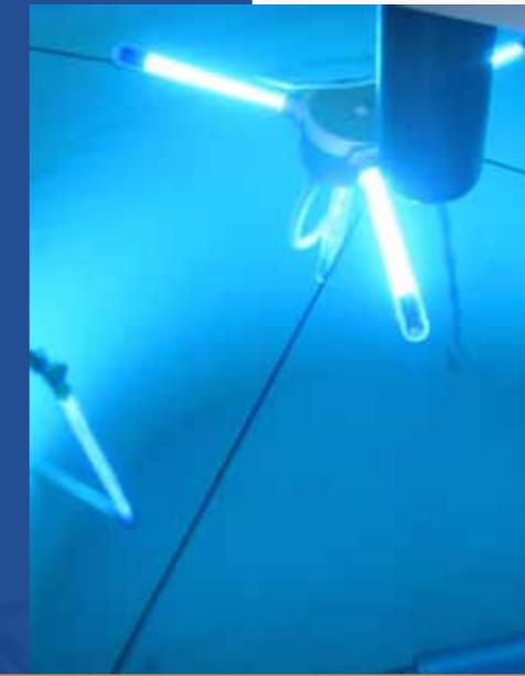
Bei großen Behältern oder Behältern mit höherem Durchfluss werden Microfloat® und Microspear® auch zusammen eingesetzt, so dass sie sich ergänzen. Die UV-Bestrahlung wird dadurch an die höhere Anforderung angepasst, um aus dem vorhandenen Behälter einen UV-Reaktor zu machen.
