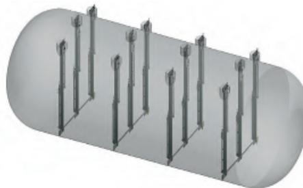
Abb. 6: Beispielhaftes Halterungssystem für UV-Tauchstrahler in KTC-Tanks
