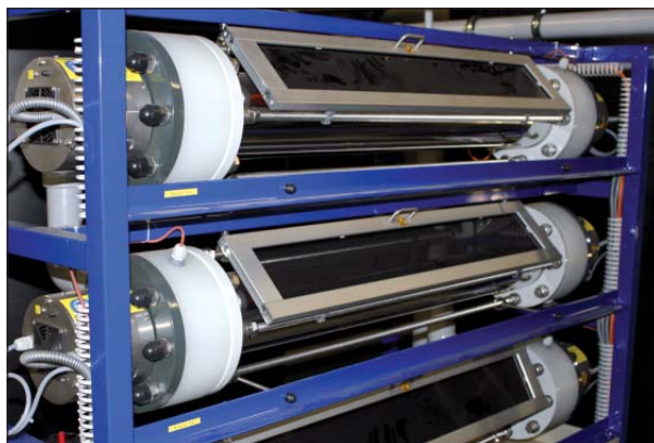
Das Herzstück der neuen Anlage: In den UV-Reaktoren wird das Abfall/Wasserstoffperoxid-Gemisch in mehreren Durchläufen mit energiereichem UV-Licht bestrahlt.
