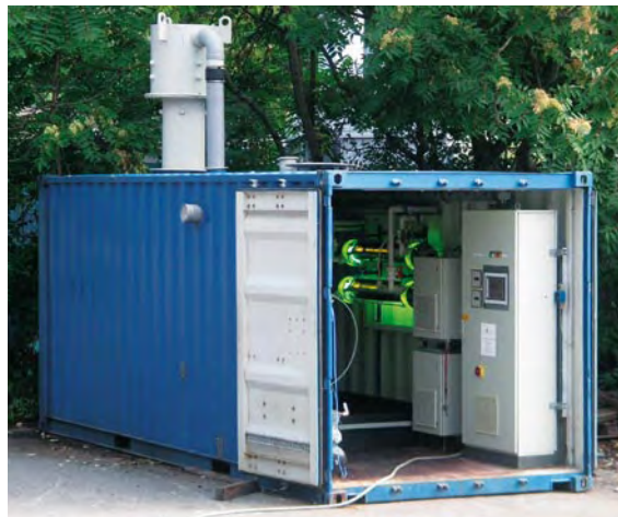
Bild 3: Das Herzstück der UV-Anlage ist der Ring-Spalt-Reaktor, in dem die Rotation zur effektiven Oxidation beiträgt
