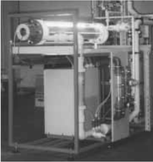
Abb. 1: Enviolet®-12-UV-Reaktor mit interner Verfahrenstechnik zur optimalen Prozessführung: In der UV-Anlage sind neben allen notwendigen Überwachungs- und Sicherheitseinrichtungen auch eine Chemikaliendosierung und Einmischung integriert. Die Leistungsteile der Anlagen sind Reaktor nah untergebracht und werden durch eine zum Patent angemeldete permanente Leistungsregelung im optimalen Betriebsbereich gefahren (Werksfoto: a.c.k.)
