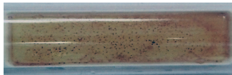
Abb. 2: Hohe Koloniezahlen ( 10^5 bis 10^6 /mL) zeigen sich sogar im VE-Wasser eines europäischen Leiterplattenherstellers mit höchsten Qualitätsansprüchen Fig. 2: High CFU (colony forming units) of ( 10^5 to 10^6 /mL) can be observed also in the d.i. water of a high quality european PCB-manufacturer
