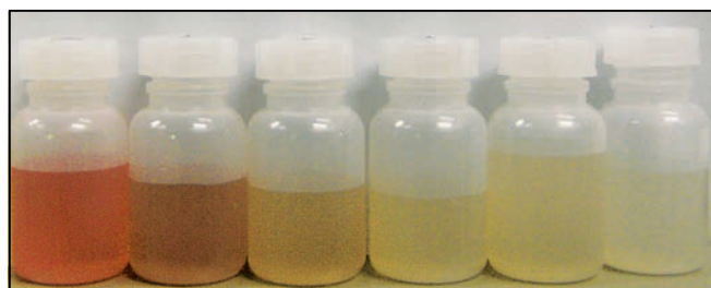
Fig. 8 - Decolorazione dell'acqua di lavaggio a scopi di riciclo
