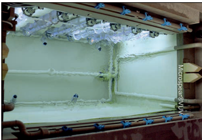
Fig. 7 - TOC-Polisher per la degradazione delle sostanze organiche interferenti nell'ultima vasca di lavaggio a monte dello scarico dei pezzi
