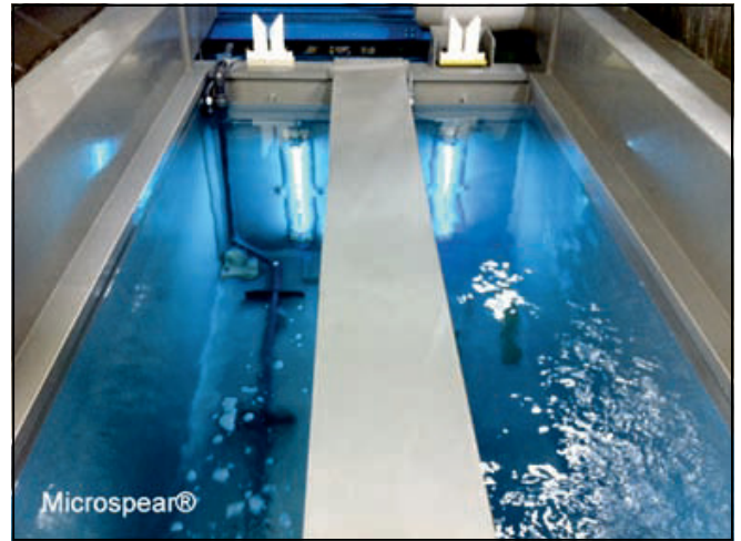
Fig. 4 – Disinfezione della vasca di lavaggio dell'elettrodeposizione
